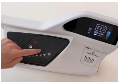
3D Formed Touch Sensor Hochschule der Medien (Germany)
